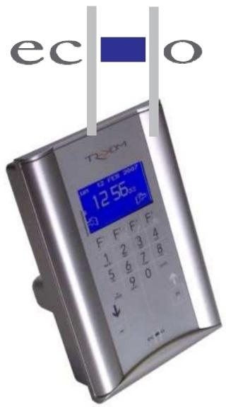
ECHO è una apparecchiatura elettronica dedicata alla raccolta dati in ambiente di lavoro: gestione presenze, controllo accessi, raccolta dati avanzamento produzione sono le classiche applicazioni nelle quali viene utilizzato ECHO.
